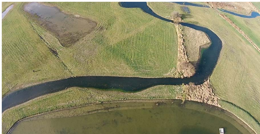
Nově vzniklý meandrující vodní tok s různým profilem a šířkou koryta. Foto Kamil Lisal
